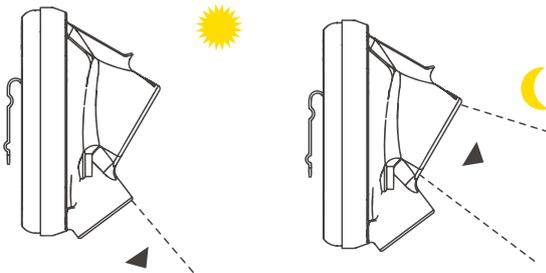
L'intensité et l'orientation du faisceau lumineux sont gérés de manière automatique par milieu d'un capteur de luminosité: il protège les yeux des utilisateurs des éblouissements et économise l'autonomie de la batterie.
